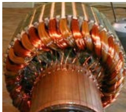
6. ábra Kommutátor és vasmagos forgórész tekercselés
