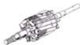
1. ábra A kalickás forgórész tekercselés (elvi rajz)
